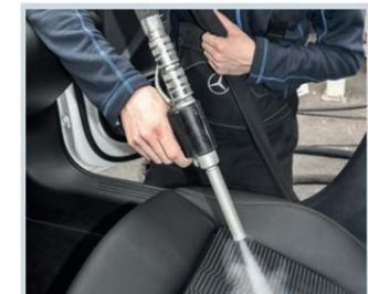
Fahrzeugreinigung - Trockeneisreinigung
